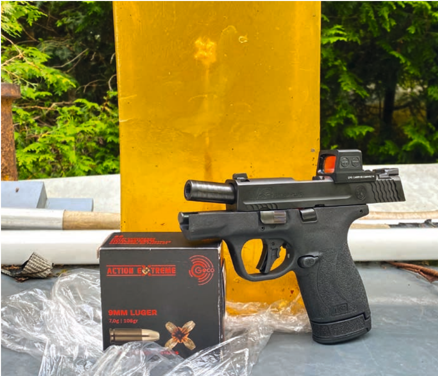
Eine bislang sichere Bank: Zum wiederholten Male spricht die 9 mm Luger GECO Action Extreme auch aus sehr kurzen Läufen in Clear Ballistics sicher an.
