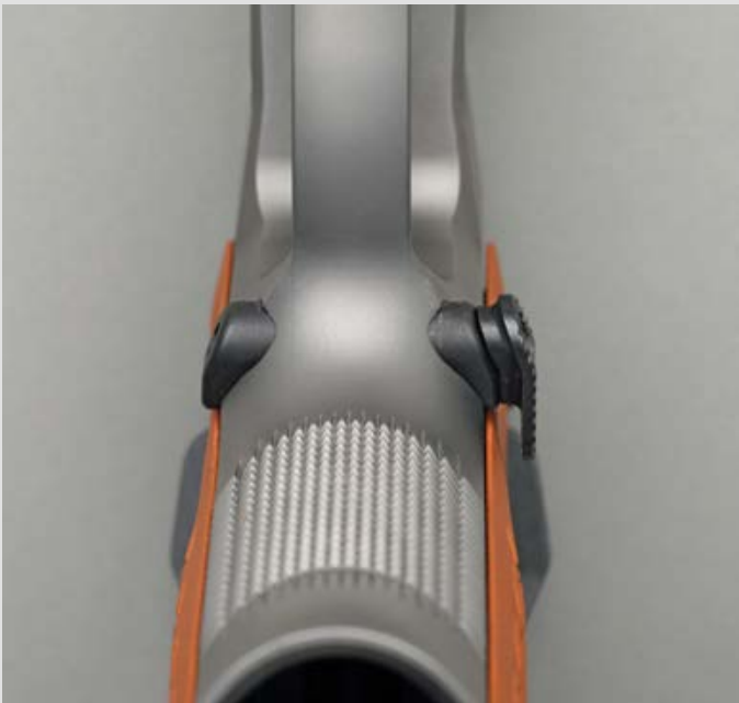
Der Magazinknopf lässt sich jederzeit von beiden Seiten betätigen.
