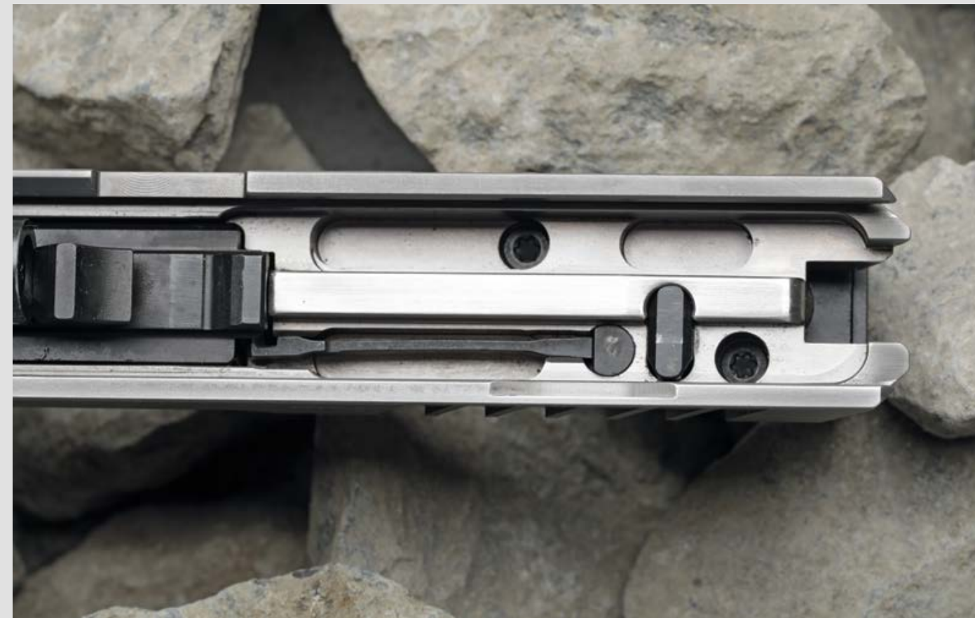
Die Steyr-Pistolen besitzen wie 1911/2011er- oder SIG P22X-Pistolen einen unter Eigenspannung stehenden Auszieher.
