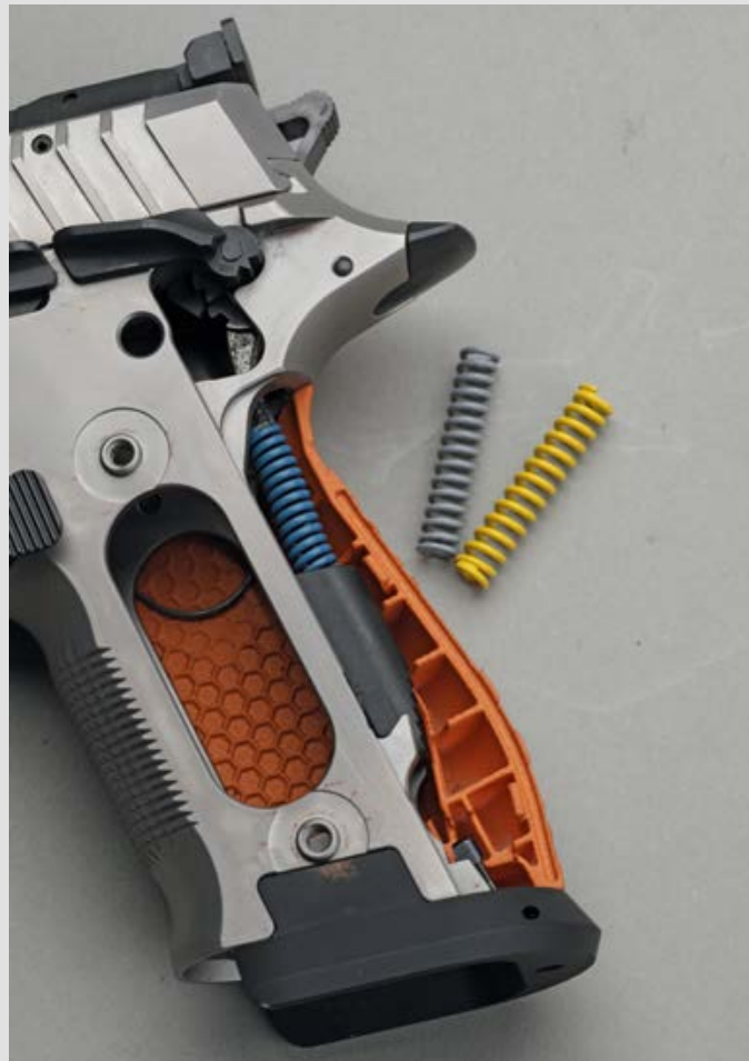
Die Schlagfedern, die den Hammer und den Schlagbolzen mit Energie versorgen, lassen sich auf die Härte der Zündhütchen abstimmen.
