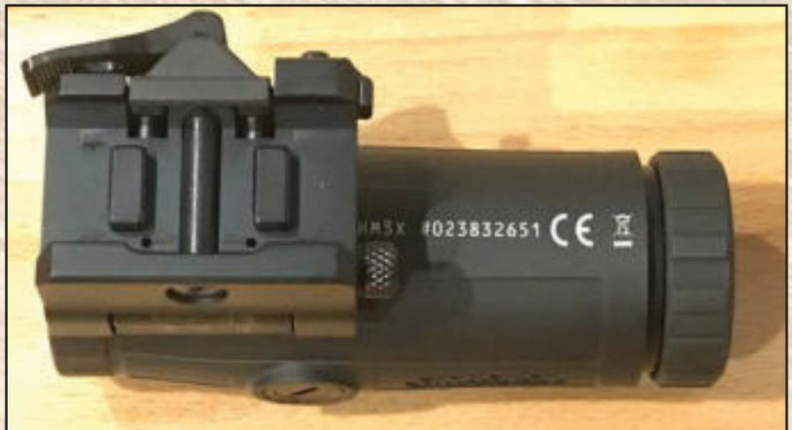
Die klappbare Pica-Montage mit Schnellverriegelung per Hebel gehört zum Lieferumfang: Hier die wichtigsten Parameter des Holosun HM3X: empfohlener Preis: 336 Euro, Maße: 102 x 43 x 67 mm (L x B x H), 28-mm-Objektiv, Dioptrien-Ausgleich +/-3 dpt, Gewicht: 280 g, Leichtmetall-Gehäuse.
