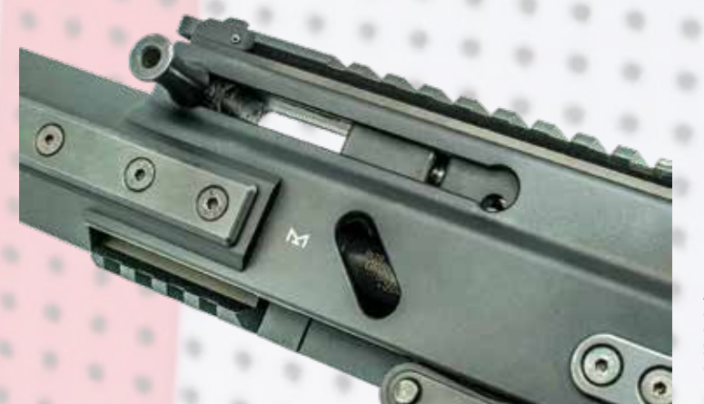
Der Ladehebel sitzt im Vorderbereich auf der linken Systemgehäusesseite und läuft während des Schusses nicht mit. Bei Bedarf kann er auf die andere Seite umgesteckt werden.
