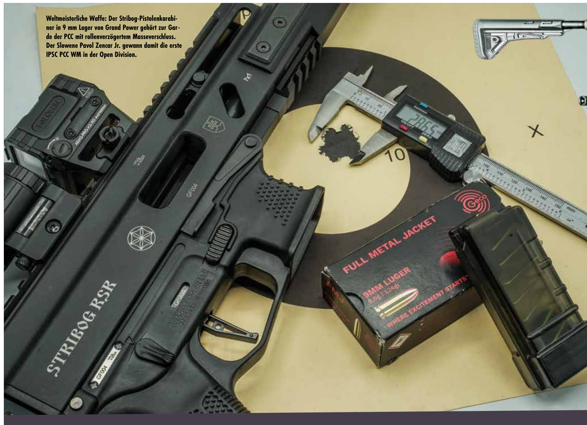
Grand Power Stribog RSR „Deutsche Version“ in der Seitenansicht. Für den Segen des BKA musste der standardmäßige M-LOK-Vorderschaft einer geschlossenen Variante weichen. Für unseren Test montierten wir eines der brandneuen Holosun AEMS Leuchtpunktvisiere, das im Design perfekt zur Stribog passt.
