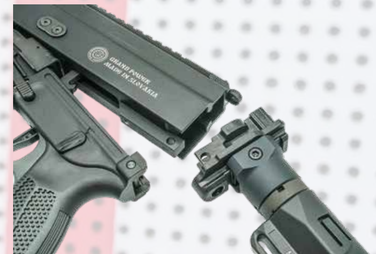
Möchte man die Verschlussgruppe entnehmen, muss die Gehäuseabschlussplatte entfernt werden. Diese dient zum einen als Widerlager für die Verschlussfeder und zum anderen wird die Schulterstütze – in unserem Fall ein AR-15-Schuldschaft – daran befestigt.
